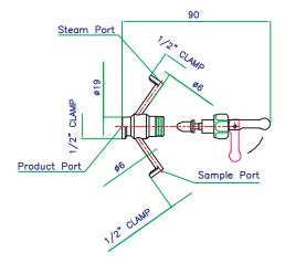
ON/OFF TOGGLE LEVER FOR MANUAL OPERATION Fig. No. VPAK-SS-ETC/UTC/SK2-8STG
