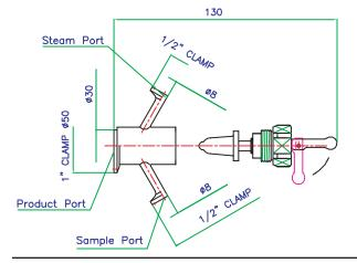
ON/OFF TOGGLE LEVER FOR MANUAL OPERATION Fig. No. VPA-SS-ETC/UTC/SK2-8STG
